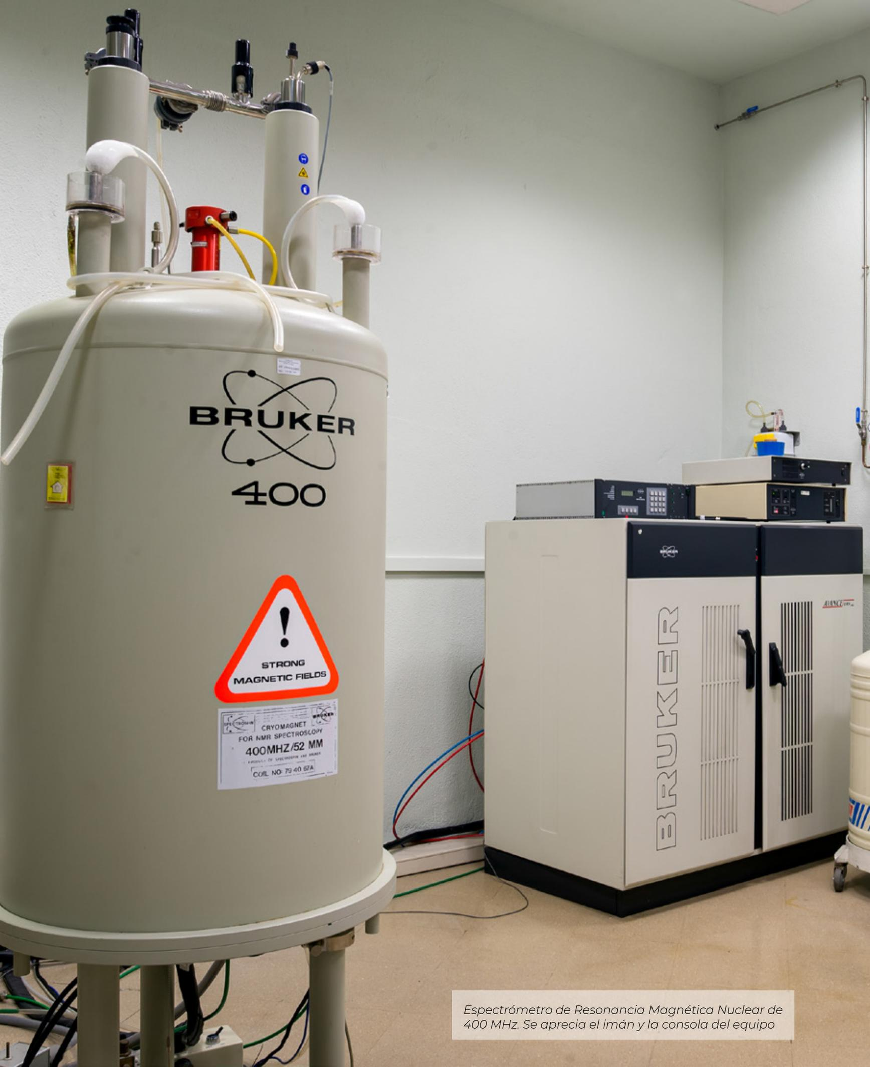
*Espectrómetro de Resonancia Magnética Nuclear de 400 MHz. Se aprecia el imán y la consola del equipo*
